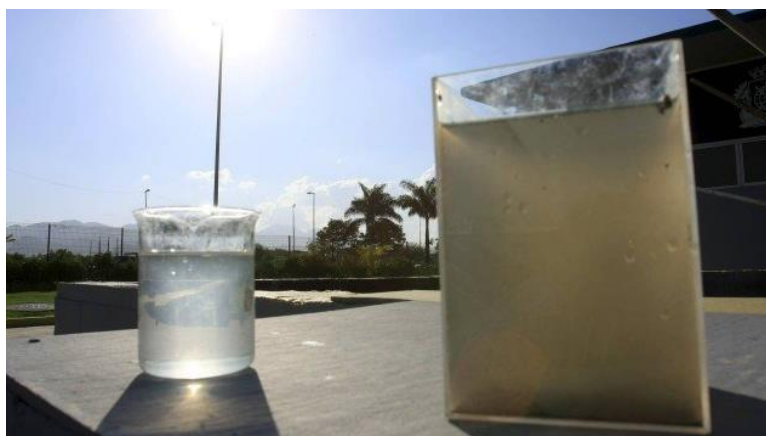
Figura 2.17: Água antes e depois do processamento da UTR de Arroio Fundo. Fonte: Ackermann (2012).
