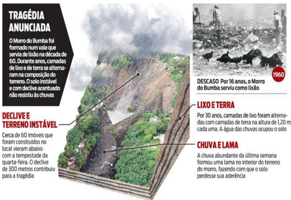
Figura 26: Desenho esquemático com os fatores contribuintes para a tragédia do Morro do Bumba.
