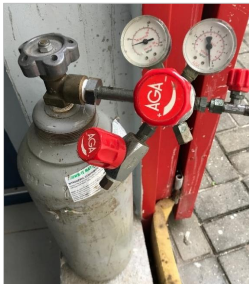
Figura 3.9: Cilindro de gás nitrogênio utilizado para retirada do oxigênio
