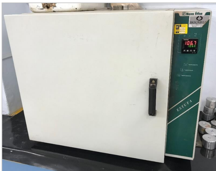
Figura 3.3: Estufa à 110 °C utilizada na determinação da umidade da tangerina
