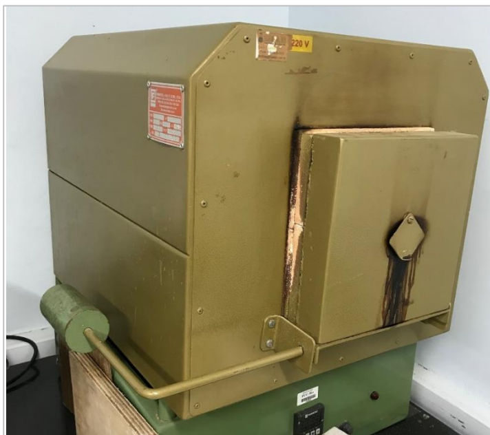
Figura 3.4: Mufla à 550 °C utilizada para a determinação de SV
