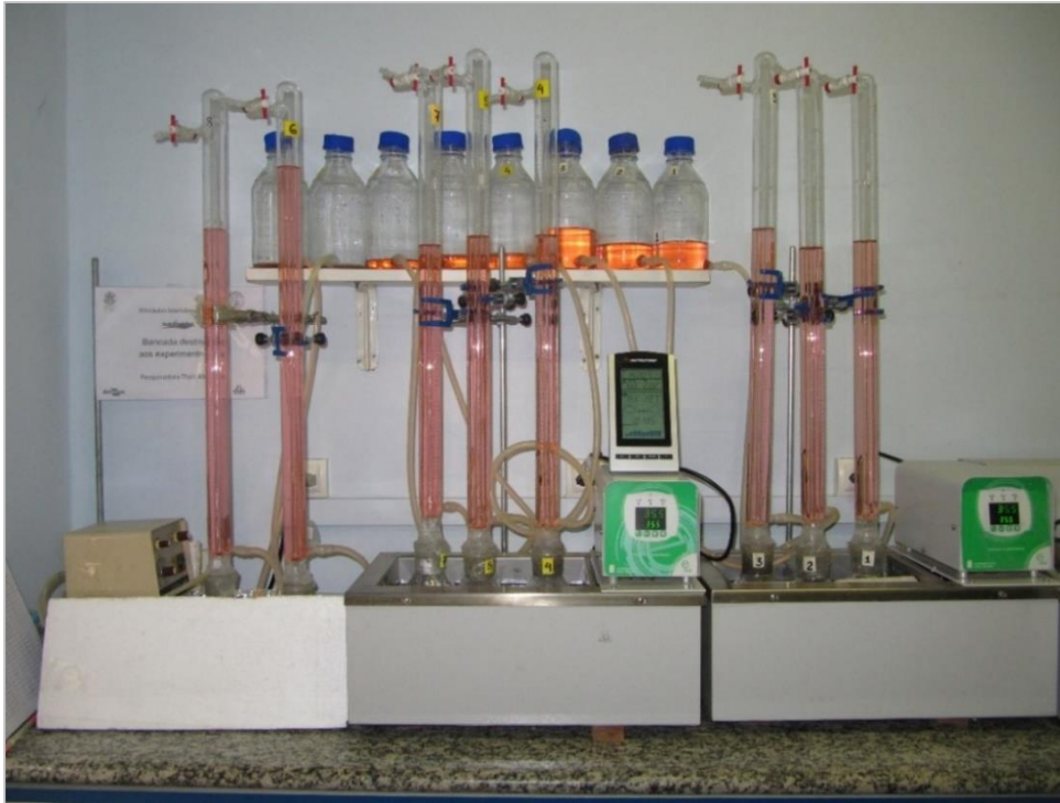
Figura 3.10: Equipamento do LGMA para realização do ensaio BMP
