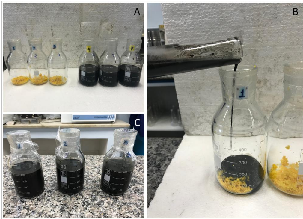
Figura 3.7: Preparo da mistura substrato-lodo para digestão anaeróbia A) da esquerda para a direita: triplicata de frascos reagente com somente substrato e triplicata de frascos reagente com somente lodo anaeróbico; B) inserção de lodo anaeróbico ao substrato; C) triplicada de frascos reagentes com mistura substrato-lodo
