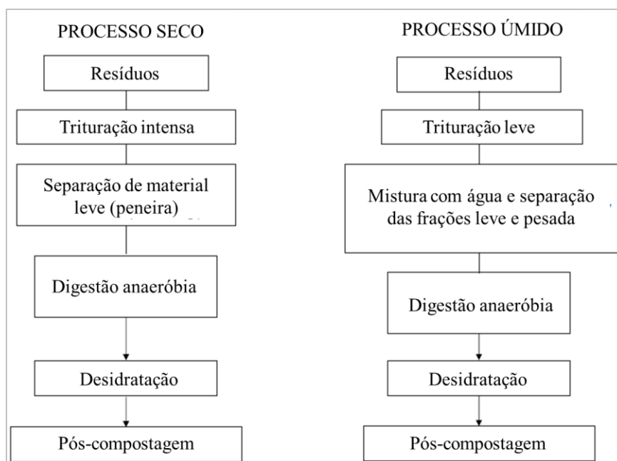
Figura 2.3: Comparação digestão anaeróbia seca e úmida Fonte: Adaptado de Grosso (2018)
