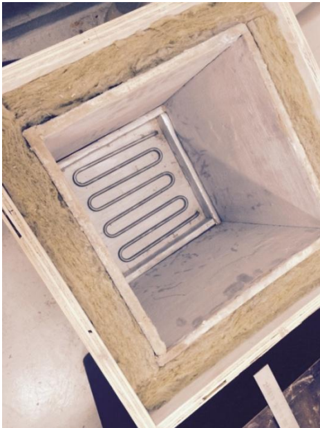
Figura 6 – Caixa de madeira isolada termicamente para acondicionamento do equipamento do Método Fluximétrico.
