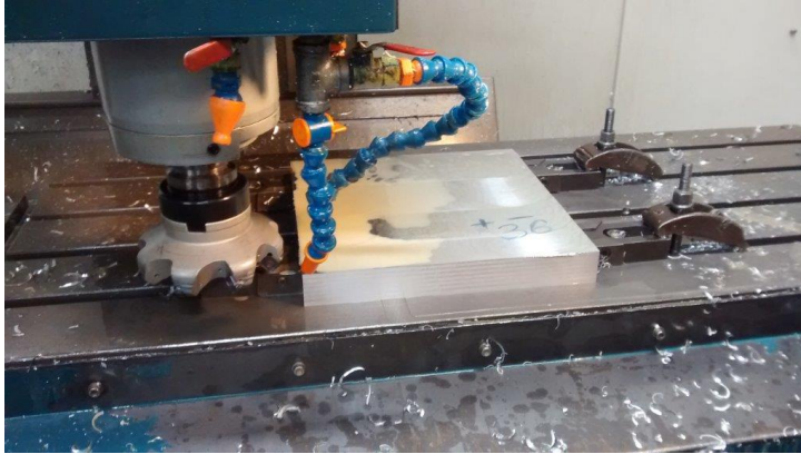
Figura 10 – Processo de usinagem da Placa Fria, Empresa Dancor (2014).
