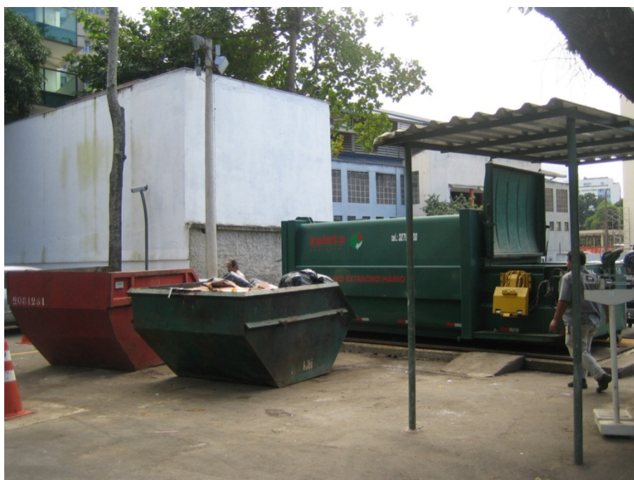
Figura 14 – Compactadora de 15m 3 localizada no Campus da PUC-Rio
