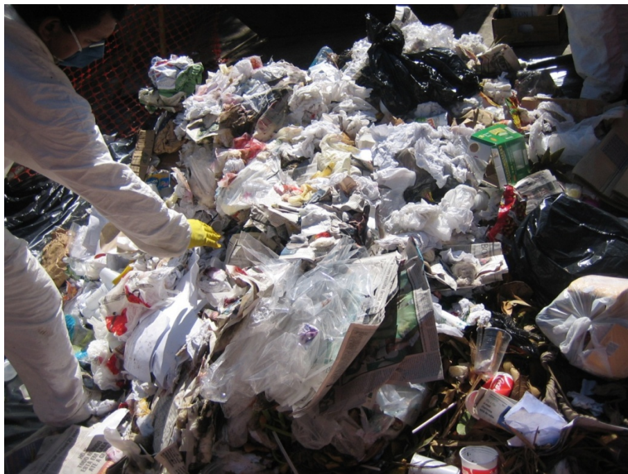
Figura 32 – Processo de quarteamento dos resíduos no ano de 2008
