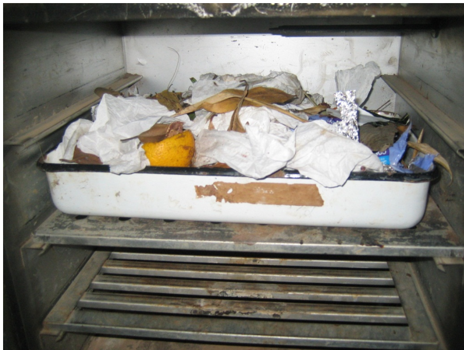
Figura 37 – Bandeja metálica com material úmido pesado na estufa
