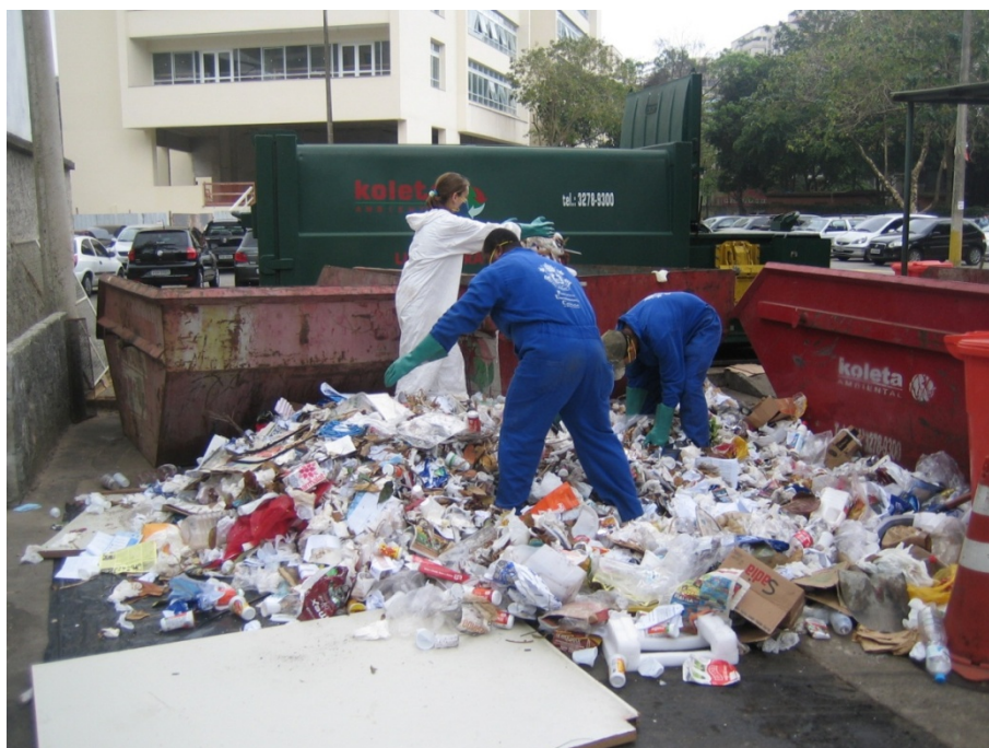
Figura 33 - Processo de quarteamento dos resíduos no ano de 2010
