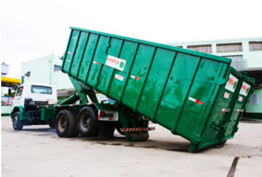
Figura 75 – Caixa Brooks e Caçamba roll-on/off (Fonte: http://www.koleta.com.br/ )
