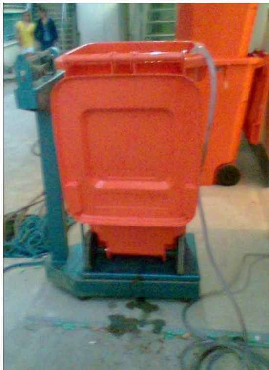
Figura 04 – Determinação da capacidade volumétrica do contentor
