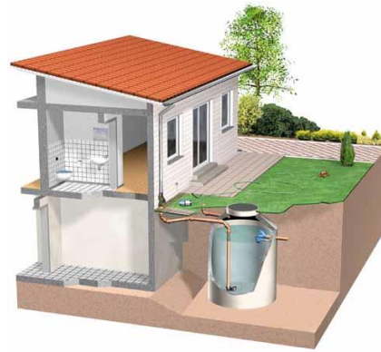
Figura 15 – sistema de tratamento de esgoto
