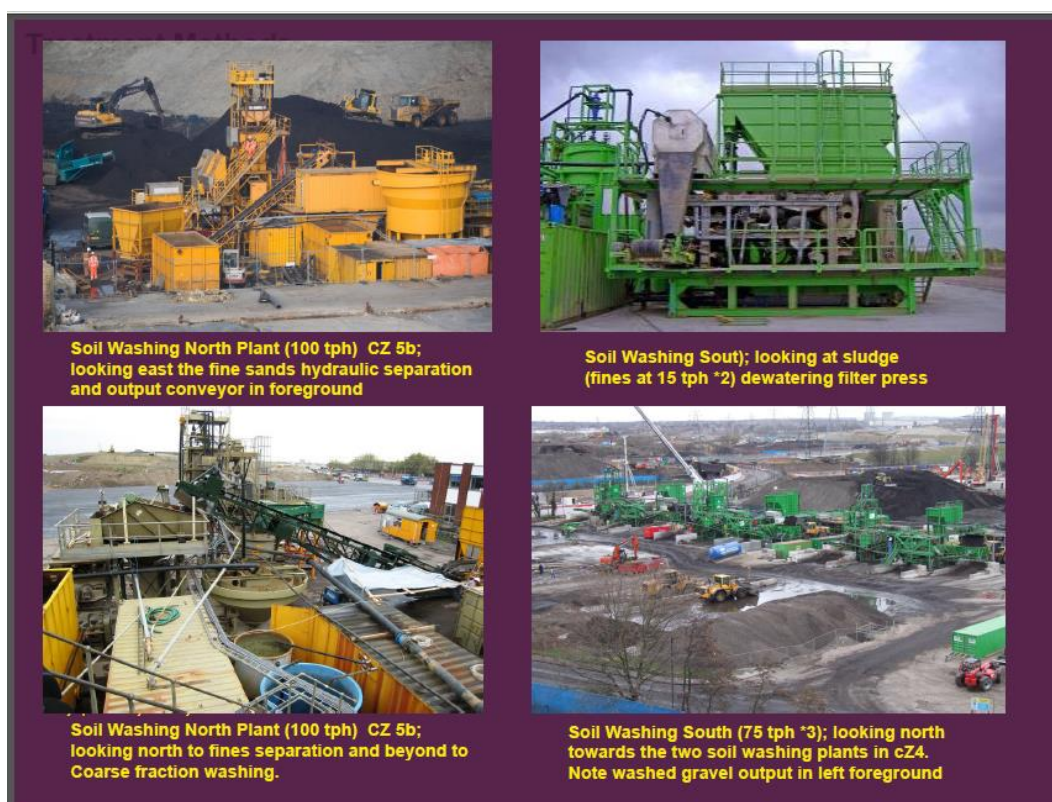
Figura 5: Técnica de lavagens de solo in situ utilizada na descontaminação do solo em Londres. Fonte: Associação Brasileira de Águas.
