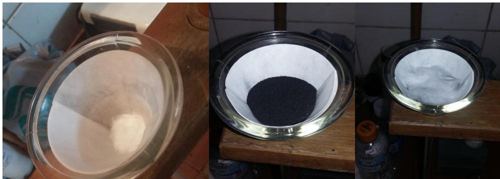
Figura 12. Montagem do filtro de carvão ativado
