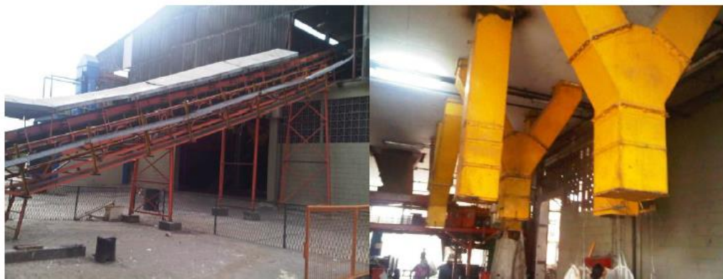
Figura 73 – Foto III - Esteira transportadora inclinada alimentadora da linha de produção e dutos de direcionamento dos resíduos do andar superior para a estocagem na Usina do Caju.
