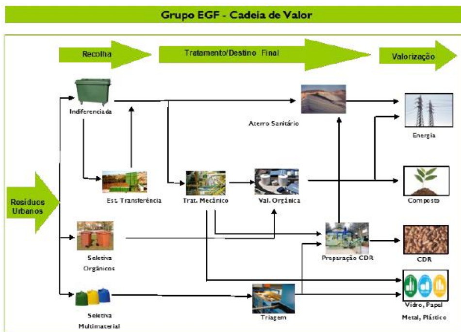
Figura 56 – Fluxo do processo de tratamento de resíduos Valnor. Fonte: PERSU II, 2006.
