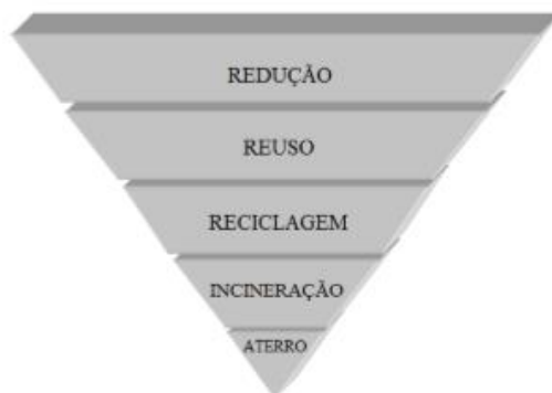
Figura 4 – Hierarquia da Gestão de Resíduos em ordem decrescente de prioridade. Fonte: Oliveira, 2012
