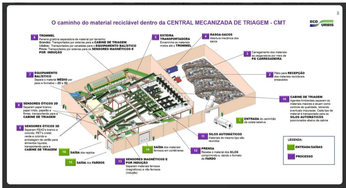
Figura 68 – Fluxo Esquemático do processo na CMT.
