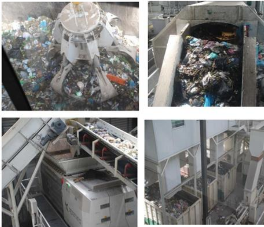
Figura 61 – Fotos de etapas do processo Valnor: 1º quadrante: Garra coletora; 2º quadrante: trommel; 3º quadrante: esteira; 4º quadrante: separação por itens em containers, a partir de cada fase do processo.
