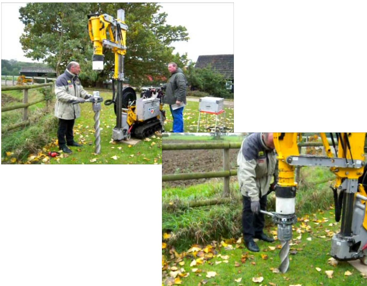
Figura 5.1 – Teste de cravação de estaca removível em Londres – Inglaterra.
