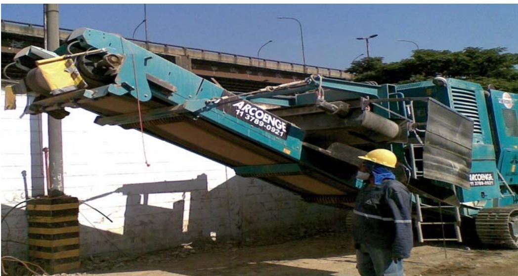
Figura 3.7 – Equipamento para britagem do entulho.
