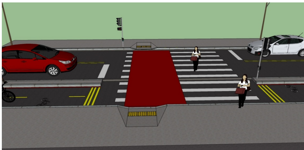
Figura 16: Desenho esquemático com rampa de acesso exigida em norma. Fonte: Autoria própria.
