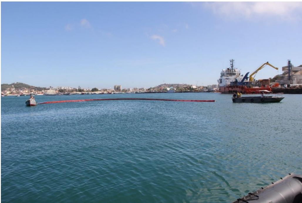
Figura 67: Treinamento simulando de vazamento de óleo com ventos de NE com a utilização de barreiras de contenção nas proximidades do Porto do Forno. Fonte: Arquivo do IEAPM.
