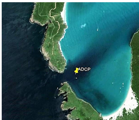
Figura 35: Posição do fundeio do ADCP, latitude de 22° 59.861' S e longitude de 42° 00.664 W, profundidade 23 metros. (BRANCO, 2000).
