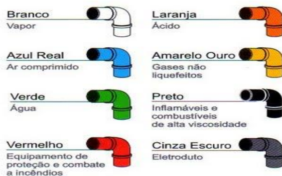
Figura 8 - Identificação por cores das tubulações.
