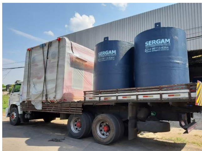
Figura 46 - Reservatórios de PRFV
