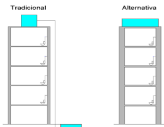
Figura 16 - Soluções para reservatórios.
