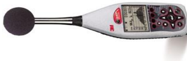
Figura: 12: Medidor de Pressão Sonora/Decibelímetro usado na avaliação Fonte: 3M – Quest – Tecnologias de medidores de níveis sonoros
