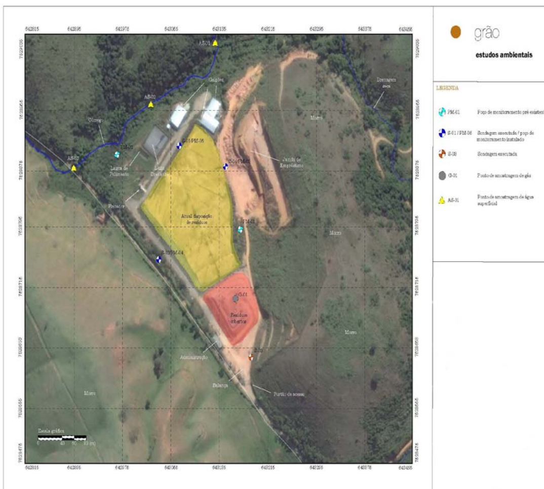
Figura 16 - Área do empreendimento com localização das sondagens, poços de monitoramento e pontos de amostragem de águas superficiais e gases.
