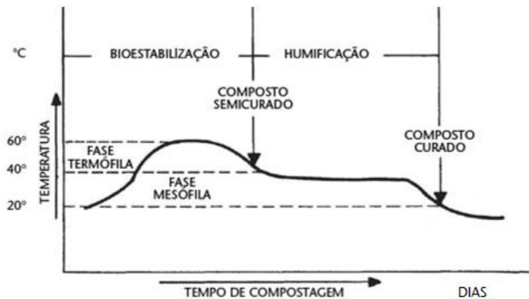
Figura 1 – Comportamento do processo de compostagem e suas fases ao longo do tempo. Fonte: Kiehl, 2004
