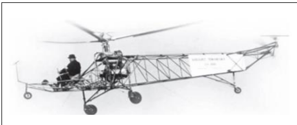
Figura 14: O VS-300 de Igor Sikorsky. Fonte: ASME, (2012).
