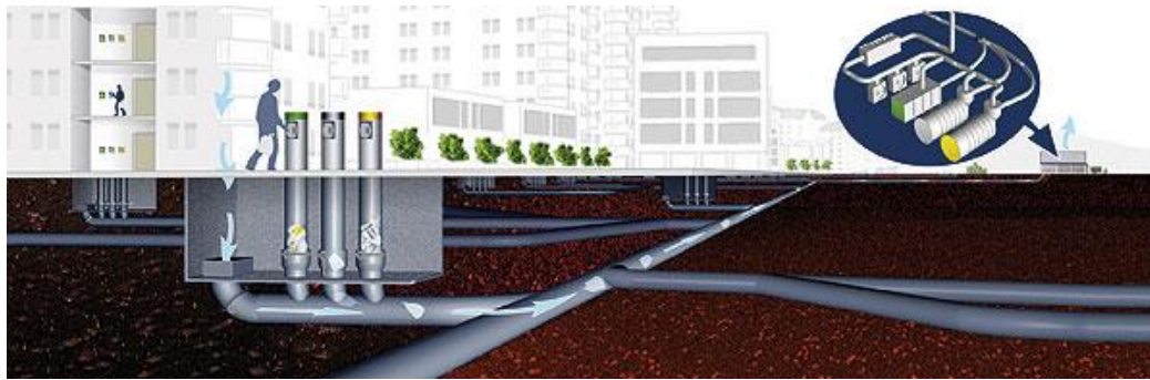
Figura 5.29: Sistema de coleta de lixo da Envac Fonte: Site da Envac
