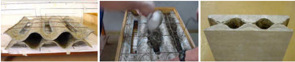
Figura 58: Painel alveolar modular de concreto com telhas de tetrapak (Fonte: Revista Habitare, 2009)
