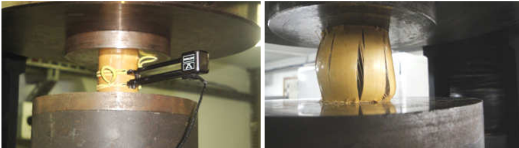
Figura 124: A) Ensaio de compressão do bambu com medida de deformação através de clip-gage colado no mesmo CP no sentido longitudinal; B) Corpo-de-prova após tensão de ruptura máxima
