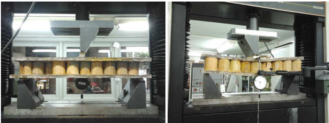
Figura 111: Painel sanduíche de bambu submetido ao ensaio de flexão
