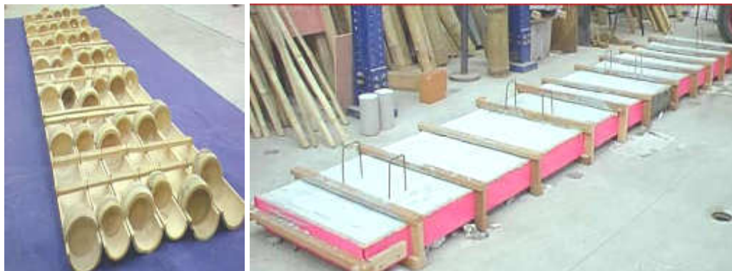
Figura 57: Laje de concreto reforçada com bambu (Achá, 2002)
