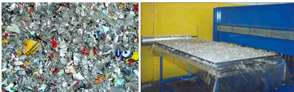
Figura 72: A) Resíduos industriais de embalagens laminadas com polietileno (Fonte: Ecoway Sistemas de Reciclagem Ltda, 2012 ); e B) Fabricação de telha reciclada de plástico e alumínio de embalagens longa vida (Fonte: Wikipédia. Autor desconhecido, 2012)
