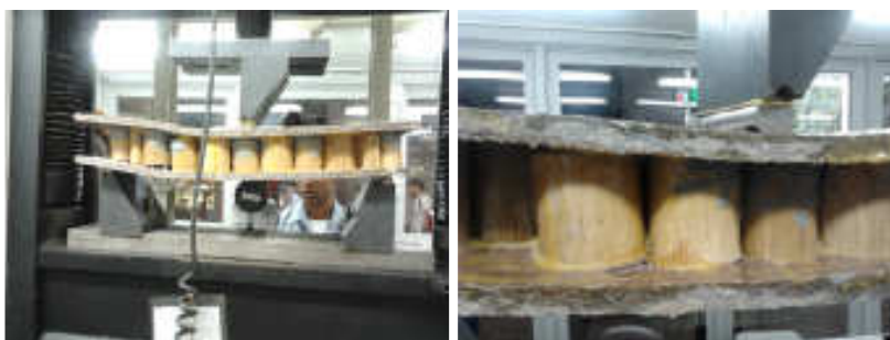
Figura 114: Deformação do painel sanduíche de bambu durante o ensaio
