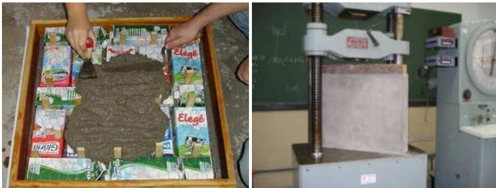
Figura 59: A) Preparação do painel; e B) Ensaio de compressão (Fonte: Nunes et. al., 2009)
