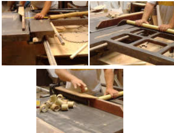
Figura 106: Sequência de preparação e corte do bambu (Marcenaria, Guaratiba, Rio de Janeiro; 2012)
