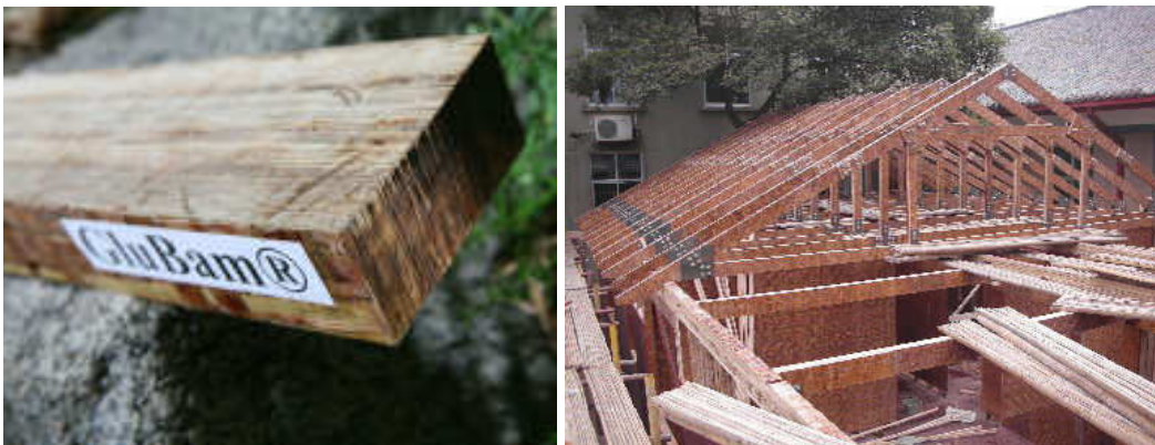
Figura 69: Bambu laminado estrutural Glubam (Fontes: Glubam; Our Everyday Earth; Inhabitat, 2012)
