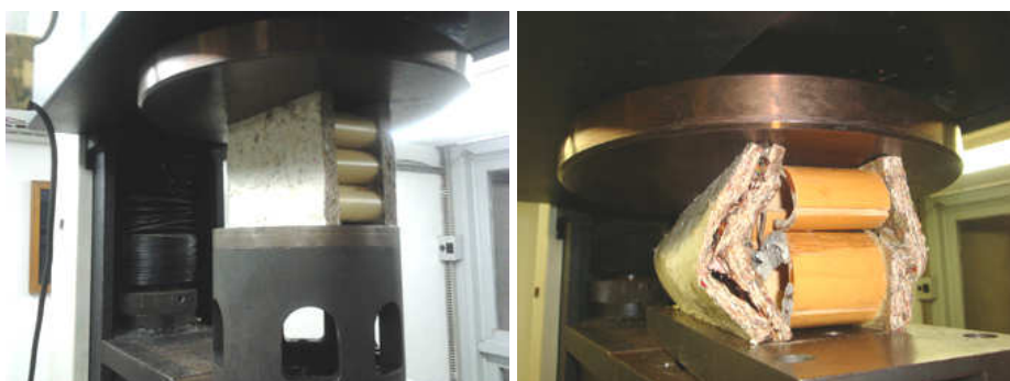
Figura 129: Ensaio de compressão do painel sanduíche de bambu
