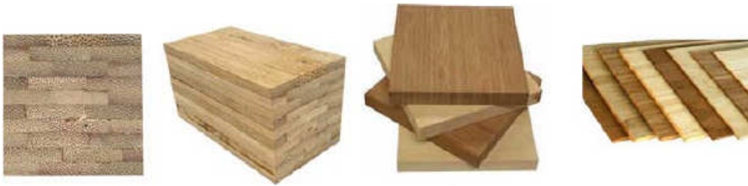
Figura 67: A) e B) bambu laminado colado (Pereira, 1997 apud Moizés, 2005); C) BLC em camadas verticais (Fonte: Zen Bamboo, apud Moizés, 2005) e D) BLC com uma camada (Fonte: C Bamboo, 2012 apud Moizés, 2005)
