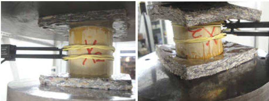
Figura 132: Aplicação da carga no sentido perpendicular do painel sanduíche de bambu
