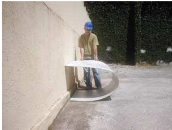
Figura 107: Flexibilidade da placa de tetrapak isolada (Fonte: Engeplas, 2010)
