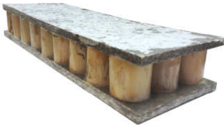
Figura 120: Painel sanduíche de bambu e tetrapak desenvolvido neste trabalho
