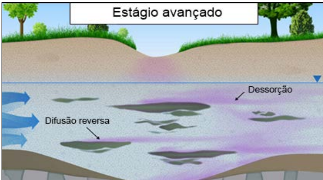
Figura 11: Exemplo ilustrativo de site impactado por DNAPL em estágio avançado, onde predominam mecanismos de sustentação da contaminação a longo prazo, como a difusão reversa e a dessorção (ITRC, 2015).
