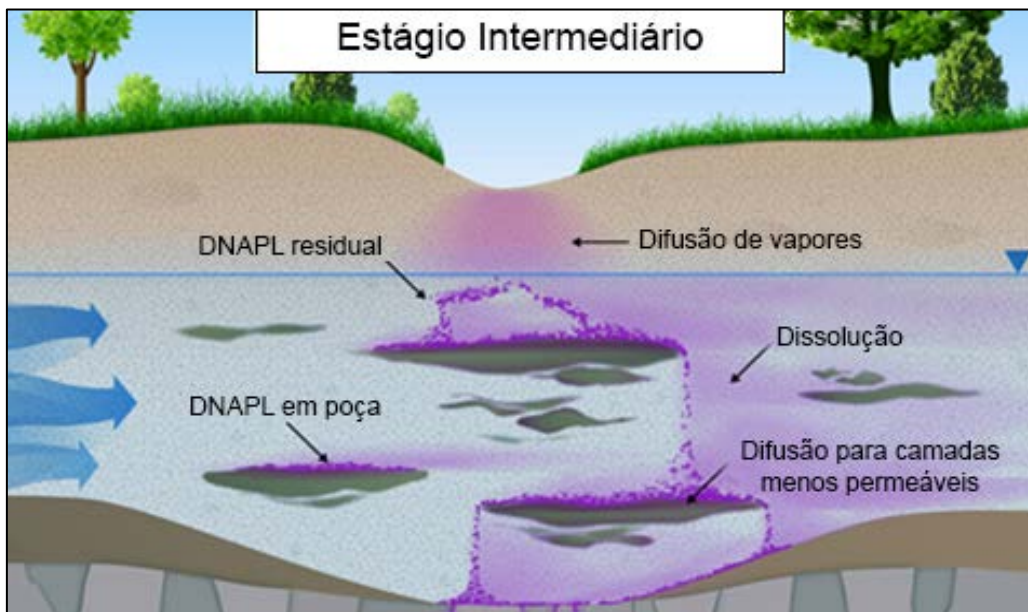
Figura 10: Exemplo ilustrativo de site impactado por DNAPLs onde não há mais fonte ativa de liberação de contaminantes. Neste estágio se dá a formação de fase residual e se iniciam processos de armazenamento de contaminantes em camadas de baixa permeabilidade (ITRC, 2015).
