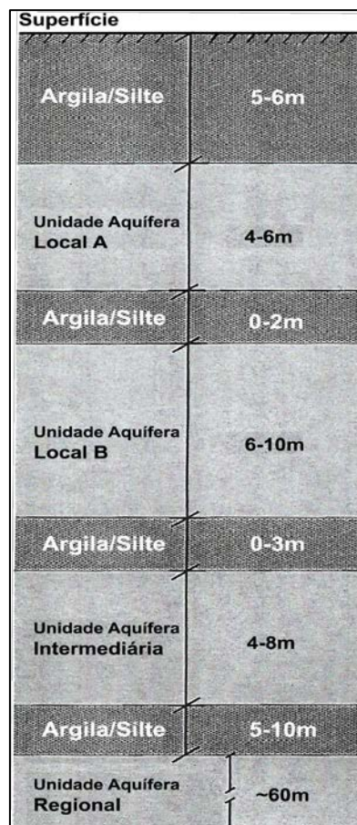
Figura 21: Perfil estratigráfico simplificado da área ilustrando a disposição e espessura das unidades aquíferas definidas e as camadas argilo-siltosas que as separam.
