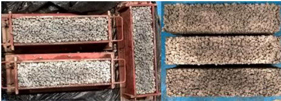
Figura 26 – Amostras do ensaio de resistência à compressão para T6 e T7
