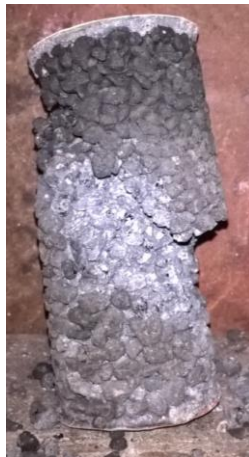
Figura 36 – Rompimento da amostra no ensaio de resistência à compressão
