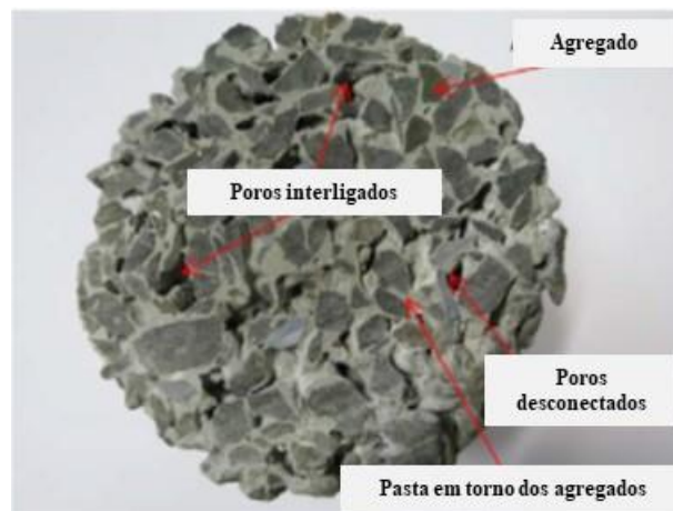
Figura 11 – Seção transversal de uma amostra de concreto permeável
