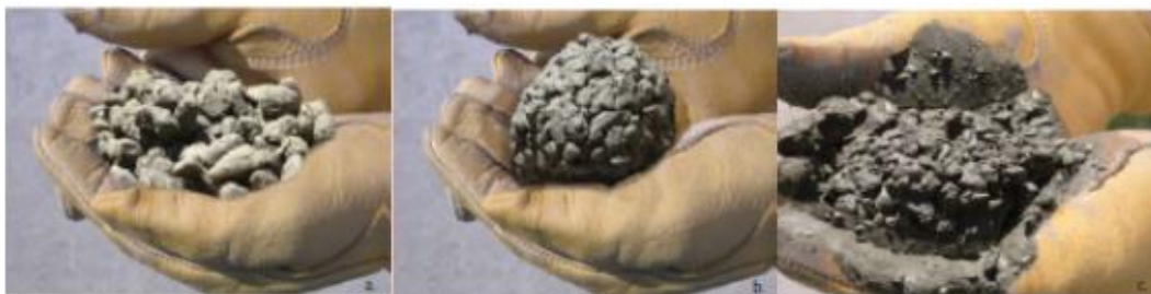
Figura 12 – Pouca água (a), quantidade ideal (b) e excessiva (c)
