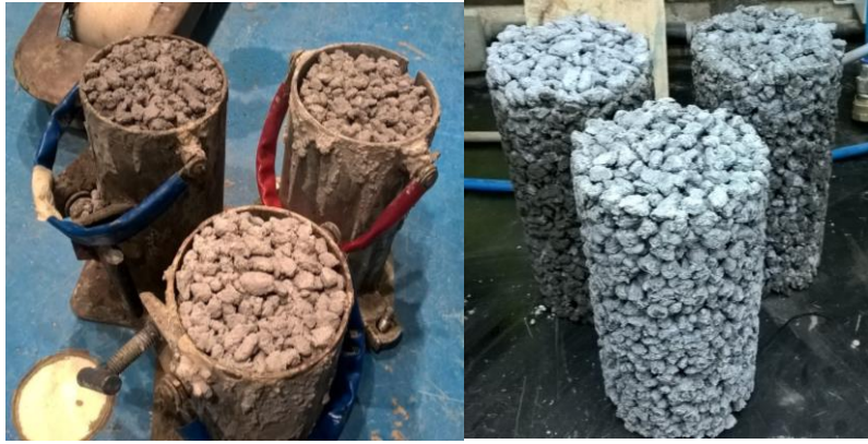
Figura 25 – Amostras do ensaio de resistência à compressão para T6 e T7
