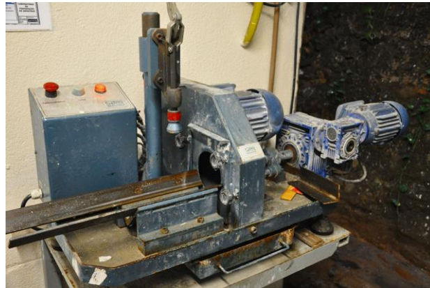
Figura 29 – Planificadora para nivelamento das amostras
