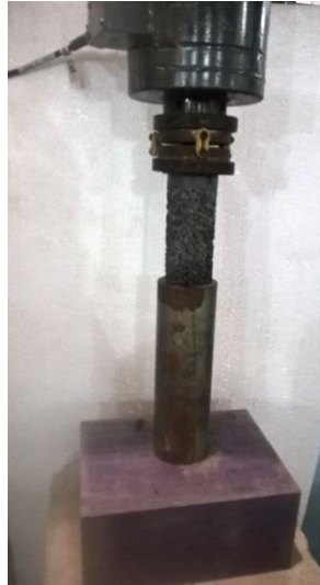
Figura 33 – Ensaio de resistência à compressão
