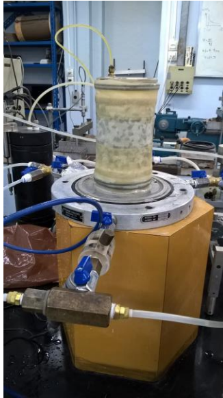
Figura 31 – Vedação das laterais com manta impermeável
