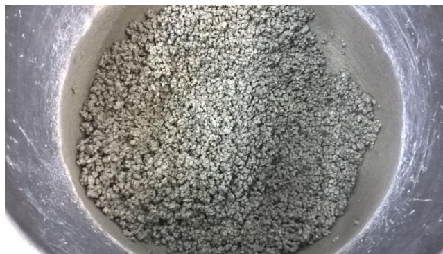
Figura 21 – Concreto permeável no estado fresco (traço T4)
