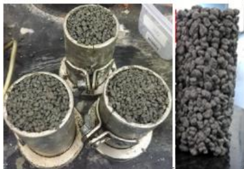
Figura 22 – Amostras do ensaio de resistência à compressão para T1 a T5
