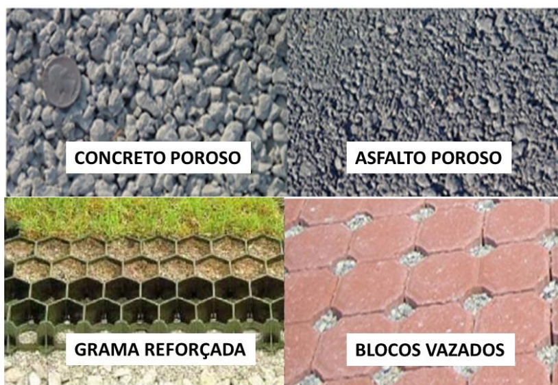
Fonte: Modificado de Collins & Hunt (2008) Figura 3 – Tipos de revestimento
