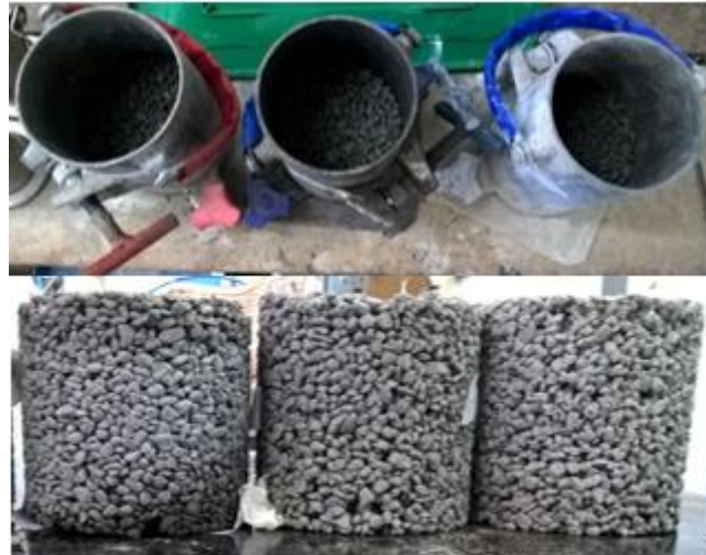
Figura 24 – Amostras do ensaio de permeabilidade para T1 a T5
