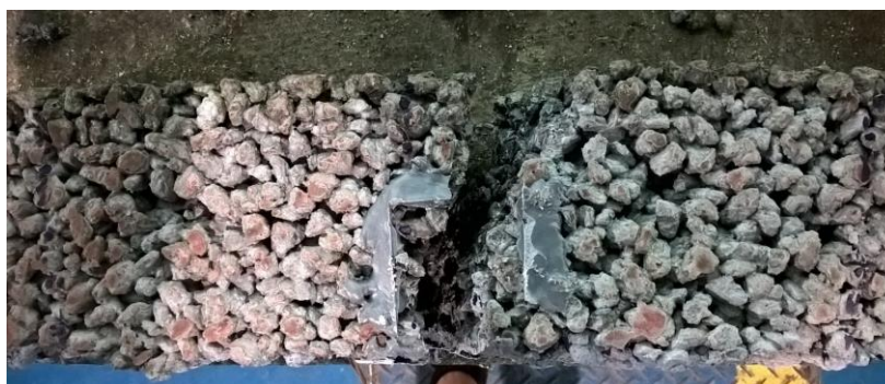
Figura 37 – Rompimento da amostra no ensaio de resistência à tração
