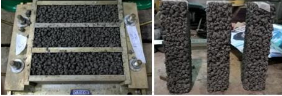
Figura 23 – Amostras do ensaio de flexão para T1 a T5
