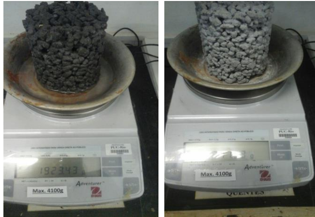
Figura 27 – Aferição da massa da amostra na condição saturada e seca
